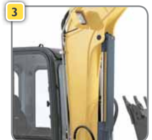
Der Auslegerzylinder ist bei jedem Einsatz optimal vor Beschädigungen geschützt
