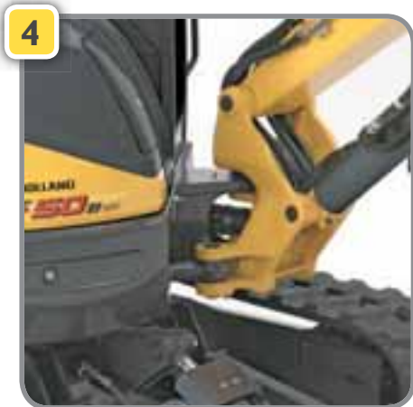
Auslegerfuß in Gussausführung + ohne freiliegende Leitungen = lange Lebensdauer
