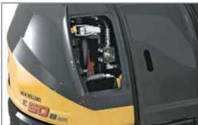
Einfach zu erreichen: Der Betriebsartenwahlschalter für den Zusatzkreislauf mit Umschaltung auf Einkreis- oder Zweikreisbetrieb.
