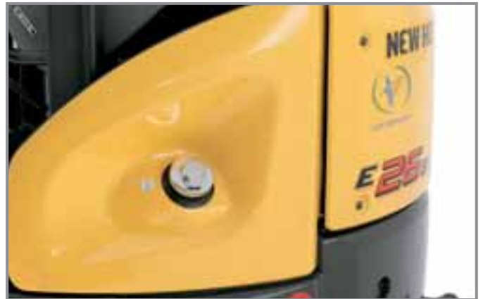
Der Dieseltank kann bequem vom Boden aus befüllt werden.
