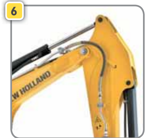
Verstärkte Löffelstiel-Lager am Ausleger
