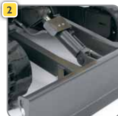
Geschützte Schlauchverbindungen = lange Lebensdauer
